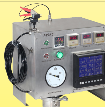
Prüfgerät zur wiederholten und konstanten Messung der maximalen Länge der Verbindungsschläuche des Luftscharters in Abhängigkeit vom Volumen des Drucktasters und dem von ihm entwickelten Druck (Ultimheat Labor)
