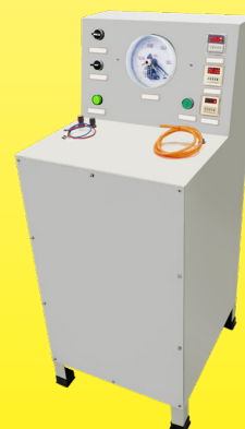
Kontrolle der Luftschalter-Betriebszyklen
